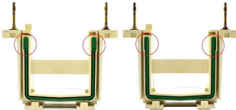
图 1. Bio-Rad 公司的 Mini-PROTEAN® Tetra Cell 电泳槽 U 型硅橡胶密封条的突起结构图。由于闪晶生物的 ShineGel™ Plus PAGE 预制胶的该部位是平的，使其兼容几乎所有厂家的小型胶电泳槽，所以电泳时须将具有突起结构的硅橡胶密封条(左图)取出后反过来安装(右图)，使其没有突起的平滑面朝外，从而防止漏液。
